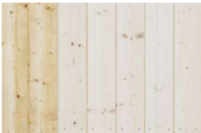
Links: Unbehandelte Fassade in Fichte Bandsägeschnitt 11 Monate nach der Montage. Rechts: Mit UVood® behandelte Fassade in Fichte Bandsägeschnitt im gleichen Zeitraum.
